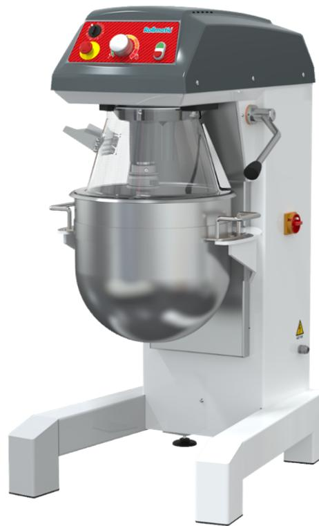
Miscelatore planetario da 60lt indicato per impasti e per il montaggio di albume, panna, pan di spagna, etc. Regolazione della velocità con inverter. Monitoraggio di sicurezza della presenza vasca e del riparo vasca. Trasmissione con scatola ad ingranaggi in bagno d'olio. Corona e pignone in acciaio in bagno d'olio, campana ingranaggi in ghisa. Versione inox su richiesta
