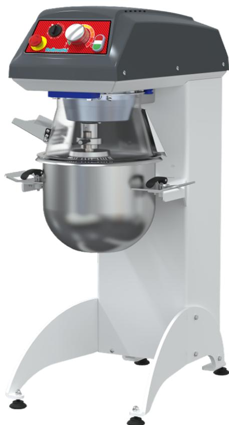
Miscelatore planetario da 20lt indicato per impasti e per il montaggio di albume, panna, pan di spagna, etc. Regolazione della velocità con inverter. Monitoraggio di sicurezza della presenza vasca e del riparo vasca. Trasmissione con scatola ad ingranaggi in bagno d'olio. Corona e pignone in acciaio, campana in alluminio anodizzato.
