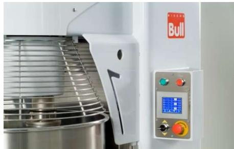
Miscelatori planetari da 100 e 160lt per applicazioni artigianali e industriali. Regolazione della velocità con inverter. Monitoraggio di sicurezza della presenza vasca e del riparo vasca. Trasmissione con scatola ingranaggi in bagno d'olio. Corona e pignone in acciaio in bagno d'olio. Disponibile anche la versione con touch screen e 100 programmi(opzione). Versioni in acciaio inox su richiesta.
