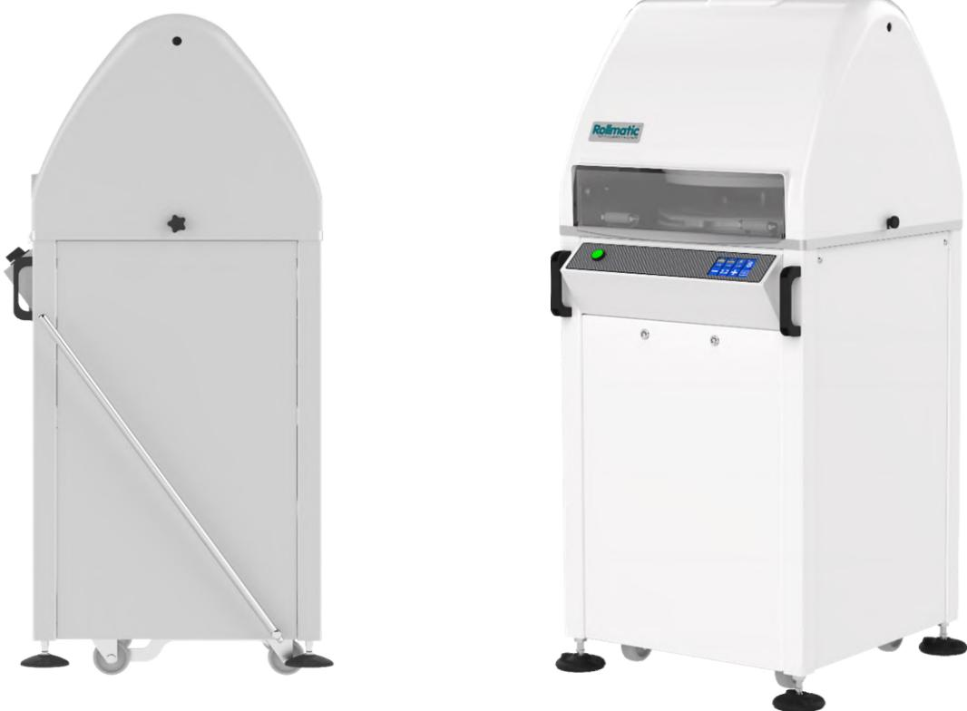
Spezza arrotondatrice automatica a tre cilindri. Touch screen da 4,5" con memorizzazione di 12 programmi, nome del programma, parametri di pressata, di apertura della camera e tempo di arrotondamento. Funzione ciclo di pulizia. Grazie alle maniglie ed al carrello azionabile a leva (opzione), la macchina può essere facilmente sollevata sulle ruote e spostata per la pulizia del pavimento
