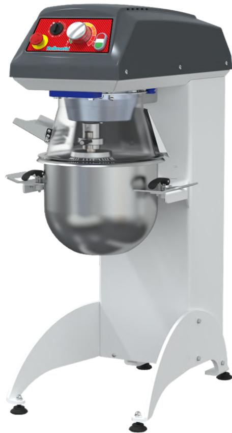
Miscelatore planetario da 20lt indicato per impasti e per il montaggio di albumi, panna, pan di spagna, etc. Regolazione della velocità con inverter. Monitoraggio di sicurezza della presenza vasca e del riparo vasca. Trasmissione con scatola ad ingranaggi in bagno d'olio. Corona e pignone in acciaio, campana in alluminio anodizzato. Coperchio superiore in acciaio verniciato. Versione inox su richiesta.
