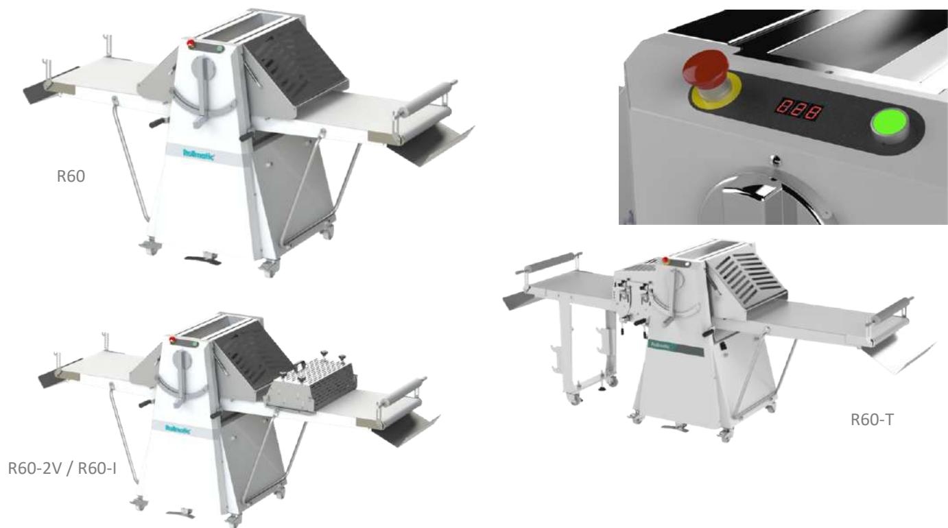
Sfogliatrice manuale con tavoli ripiegabili ed estraibili. Inversione del ciclo di lavoro con barra e pedaliera, protezioni dei cilindri in inox con micro di sicurezza e molla a gas. Disponibile con velocità singola, 2 velocità(R60-2V) o inverter(R60-I). La versione R60-T ha il gruppo di taglio incorporato a vantaggio di una maggior superficie di lavoro sul tavolo. Lettura digitale dell'apertura dei cilindri(opzione)
