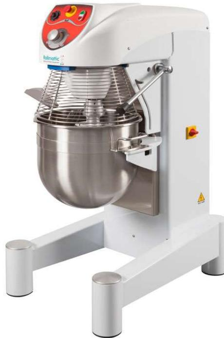
Miscelatore planetario da 60lt indicato per impasti e per il montaggio di albume, panna, pan di spagna, etc. Regolazione della velocità con inverter. Monitoraggio di sicurezza della presenza vasca e del riparo vasca. Trasmissione con scatola ad ingranaggi in bagno d'olio. Corona e pignone in acciaio in bagno d'olio, campana ingranaggi in ghisa. Versione inox su richiesta
